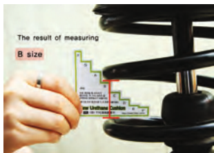
измерение шага пружины измерителем
