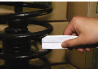
измерение шага пружины линейкой
