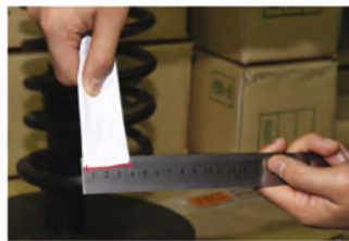
измерение шага пружины линейкой
